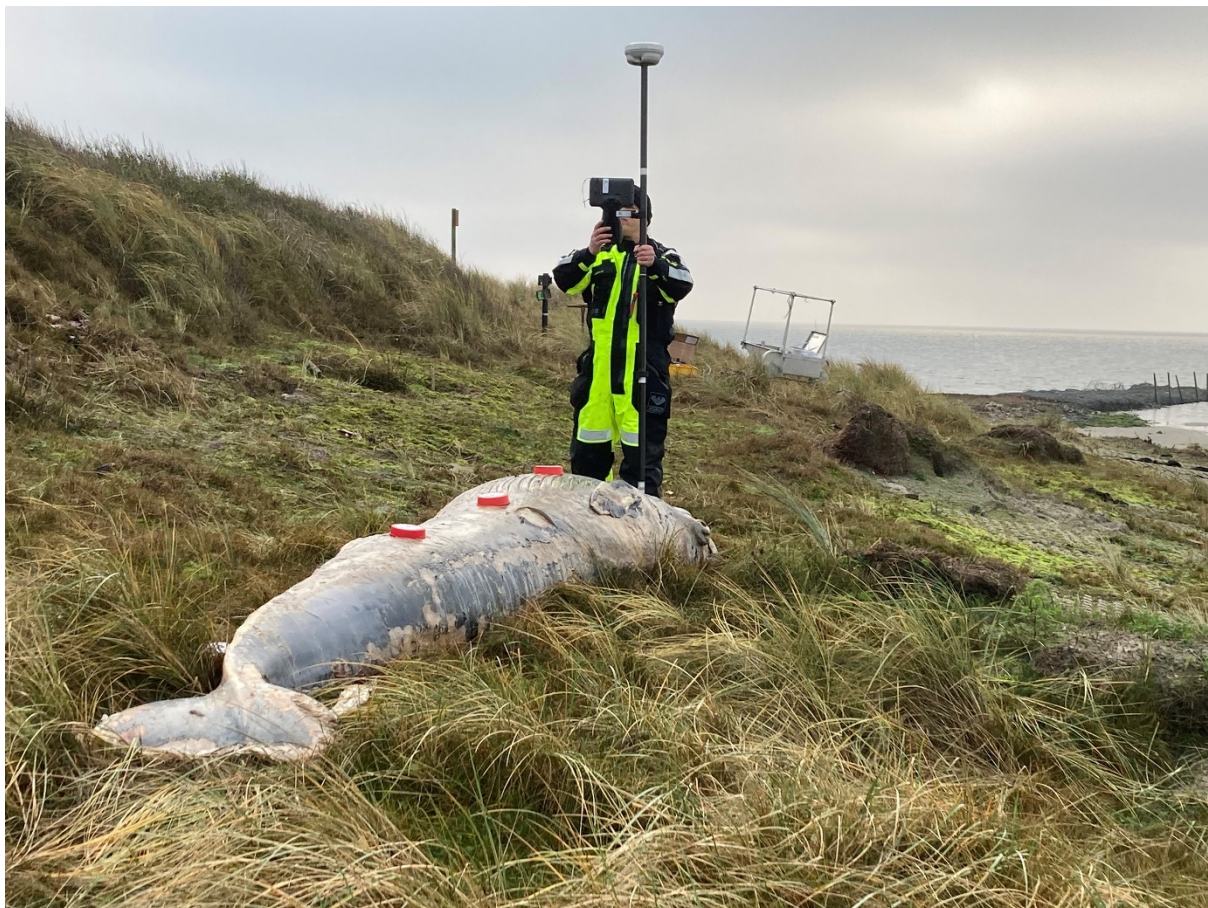
Figuur 3. Inmeten van Ground Control Points. Foto: Jan Kostwinner, Waddenunit.
