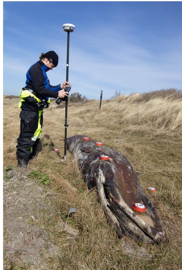
Figuur 3. Inmeten van de Ground Control Points. Foto: Nicole Janinhoff-Verdaat, 30-03-2021.
