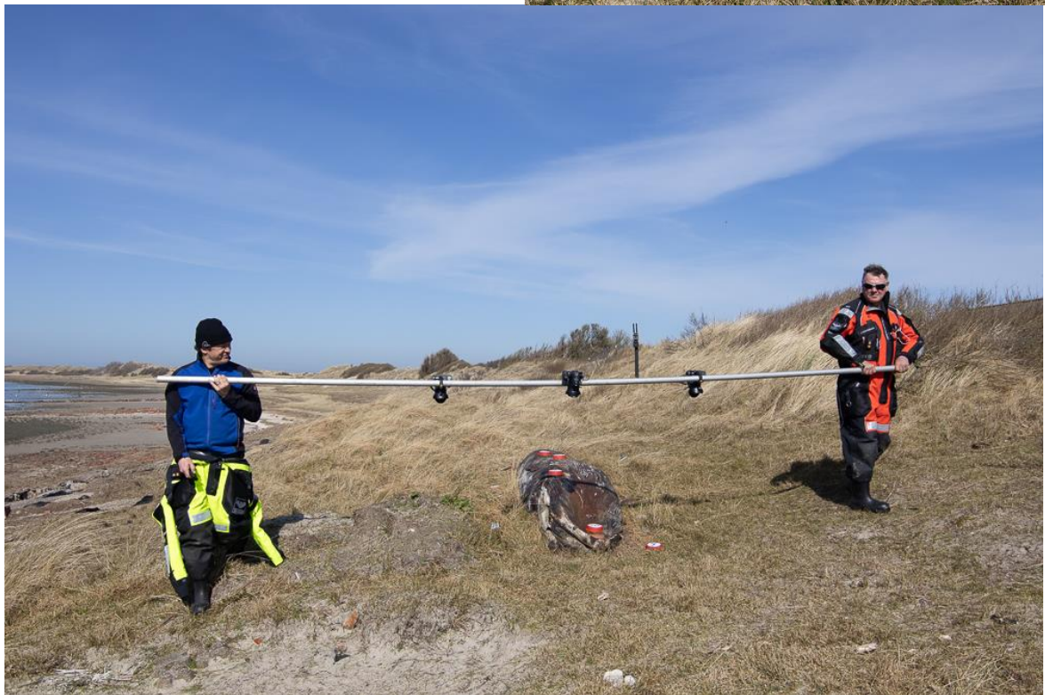
Figuur 4. Drie fototoestellen met groothoeklens en afstandsbediening voor het maken van de orthofoto's van het kadaver. Foto: Nicole Janinhoff-Verdaat, 30-03-2021.
