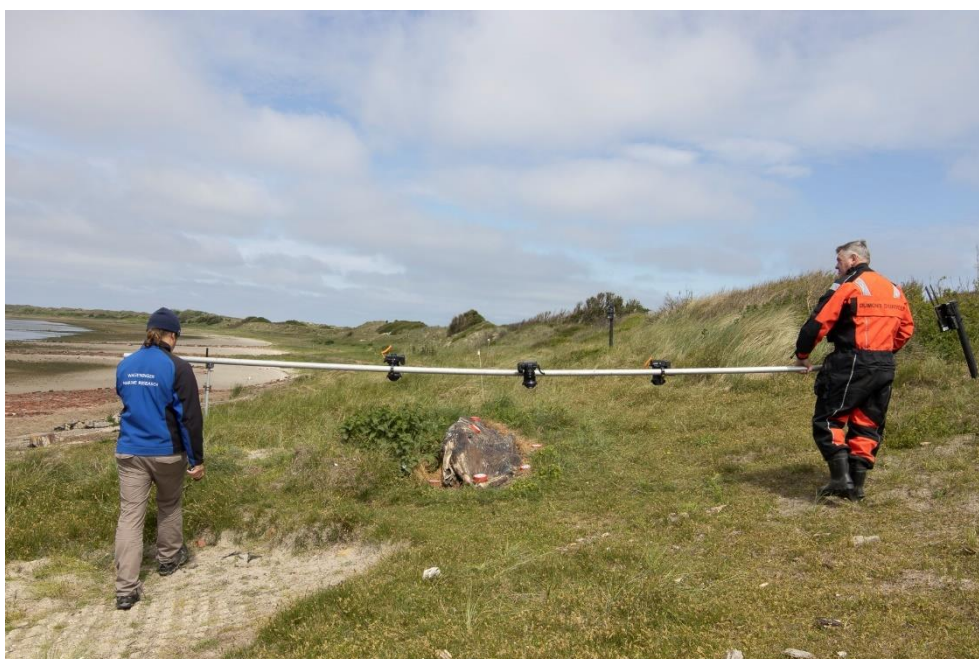
Figuur 4. Drie fototoestellen met groothoeklens en afstandsbediening voor het maken van de orthofoto's van het kadaver. Foto: Marinka van Puijenbroek, Wageningen Marine Research, 28-05-2021.
