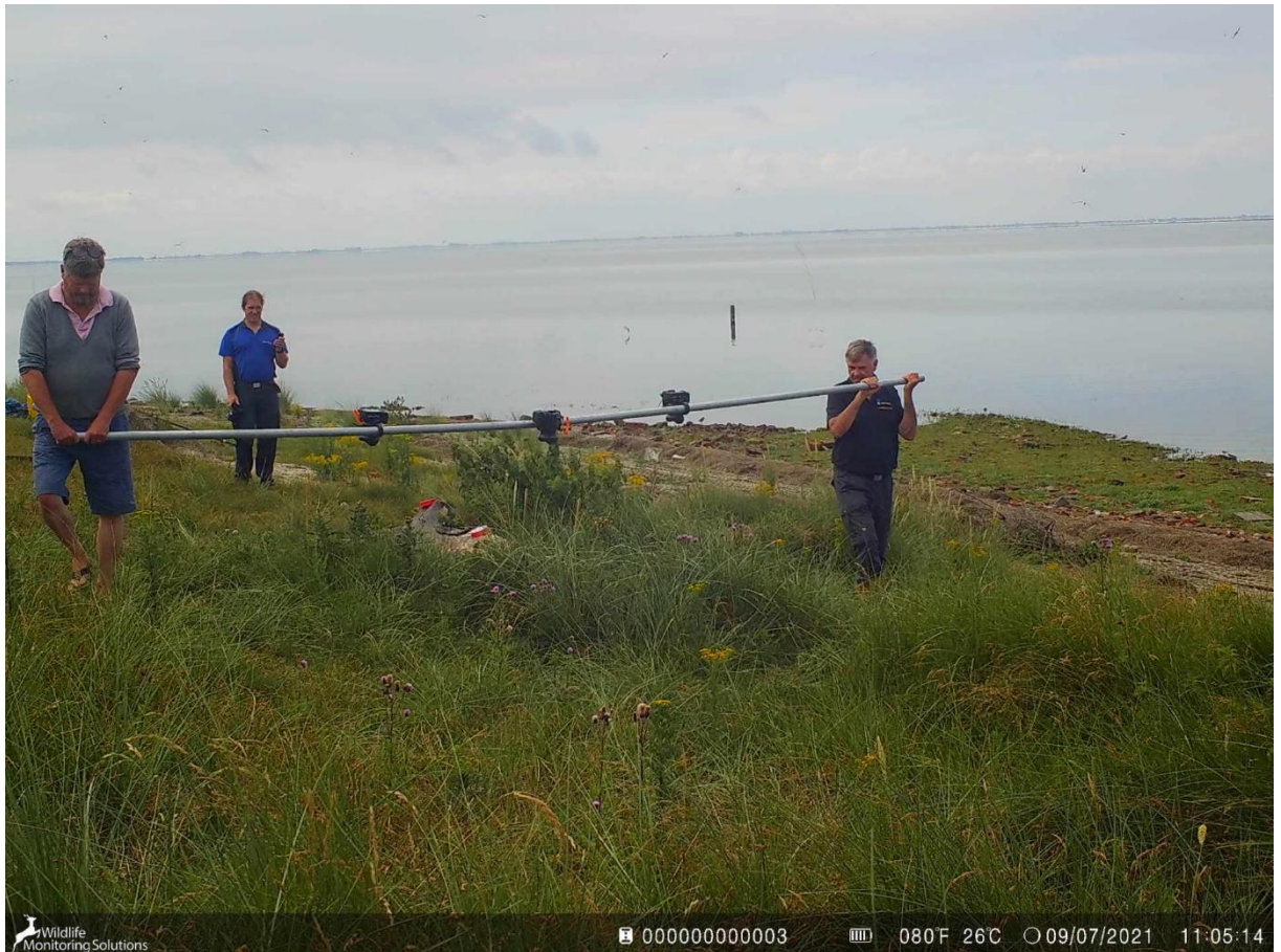
Figuur 3. Drie fototoestellen met groothoeklens en afstandsbediening voor het maken van de orthofoto's van het kadaver. Foto: Wageningen Marine Research, 09-07-2021.
